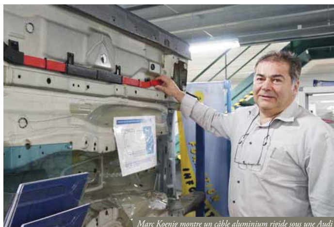
Marc Koenig montre un câble aluminium rigide sous une Audi
