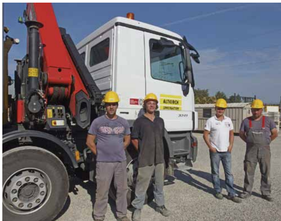
Samuel Schmidt (en polo blanc) et ses coéquipiers Camion porteur 8x4 équipé d'une grue de 15 mètres avec une portée d'une tonne en haut de flèche. Ce camion totalement télécommandé assure une mobilité sur les chantiers, contrairement à la grue fixe.
