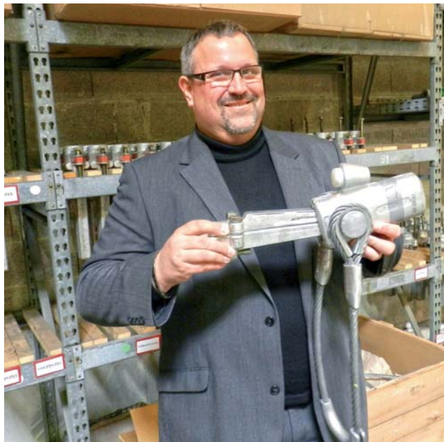
Michel Bartissol et un serre-câble de tirage type UPK, nécessaire pour fixer le câble et le tirer complètement sur la ligne aérienne. Outil de serrage à coinement conique pour la pose et la maintenance de lignes aériennes.
