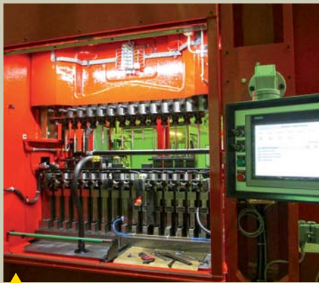
Cette machine de haute technicité scelle 16 rangs de balles simultanément et son système de commande est entièrement informatisé
