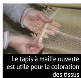
La matière première reste le fil. Ici, un cantre pour le dérouler
